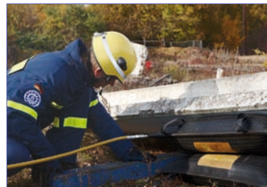
Das Hebekissen zur Anhebung von schweren Lasten
